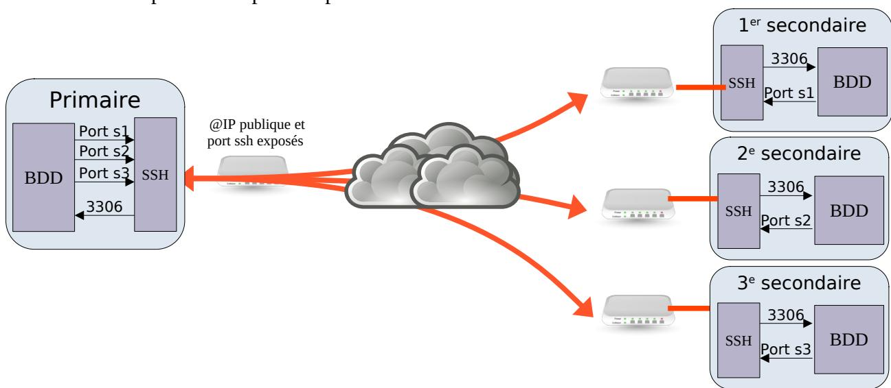
Un exemple de commande permettant d'activer ce type de tunnelling à partir d'un secondaire : `/usr/bin/ssh -NT -o ServerAliveInterval=60 -o ExitOnForwardFailure=yes -p port_ssh_exposé -L port_s1:localhost:3306 -R port_s1:localhost:3306 replication@IP secondaire`
